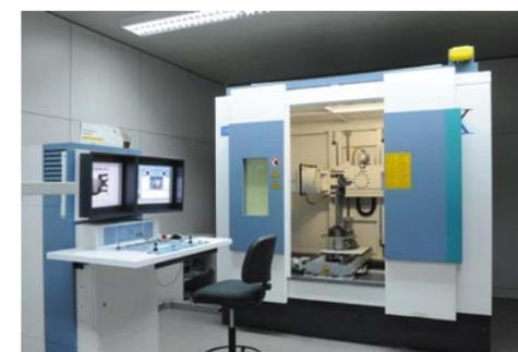
Machine de contrôle interne de la structure en aluminium avec des rayons X
