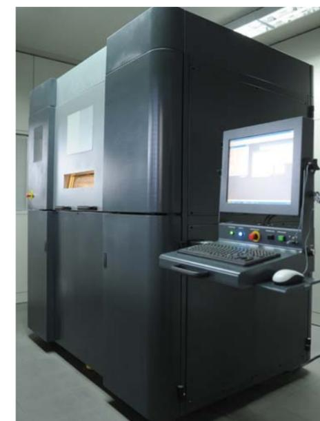
Pour le développement de nouveaux composants, il existe une machine de prototypage rapide, où on applique le procédé de laser sintering.
