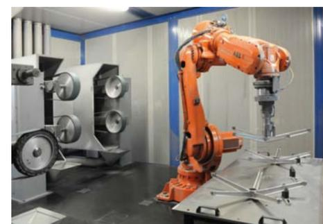
Polissage des surfaces en aluminium en utilisant des robots
